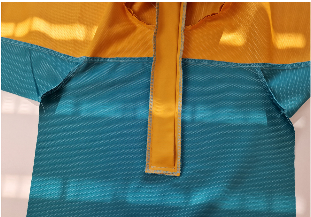
26. Z RS poté začistíme švové přídávky našité légy overlockem.
