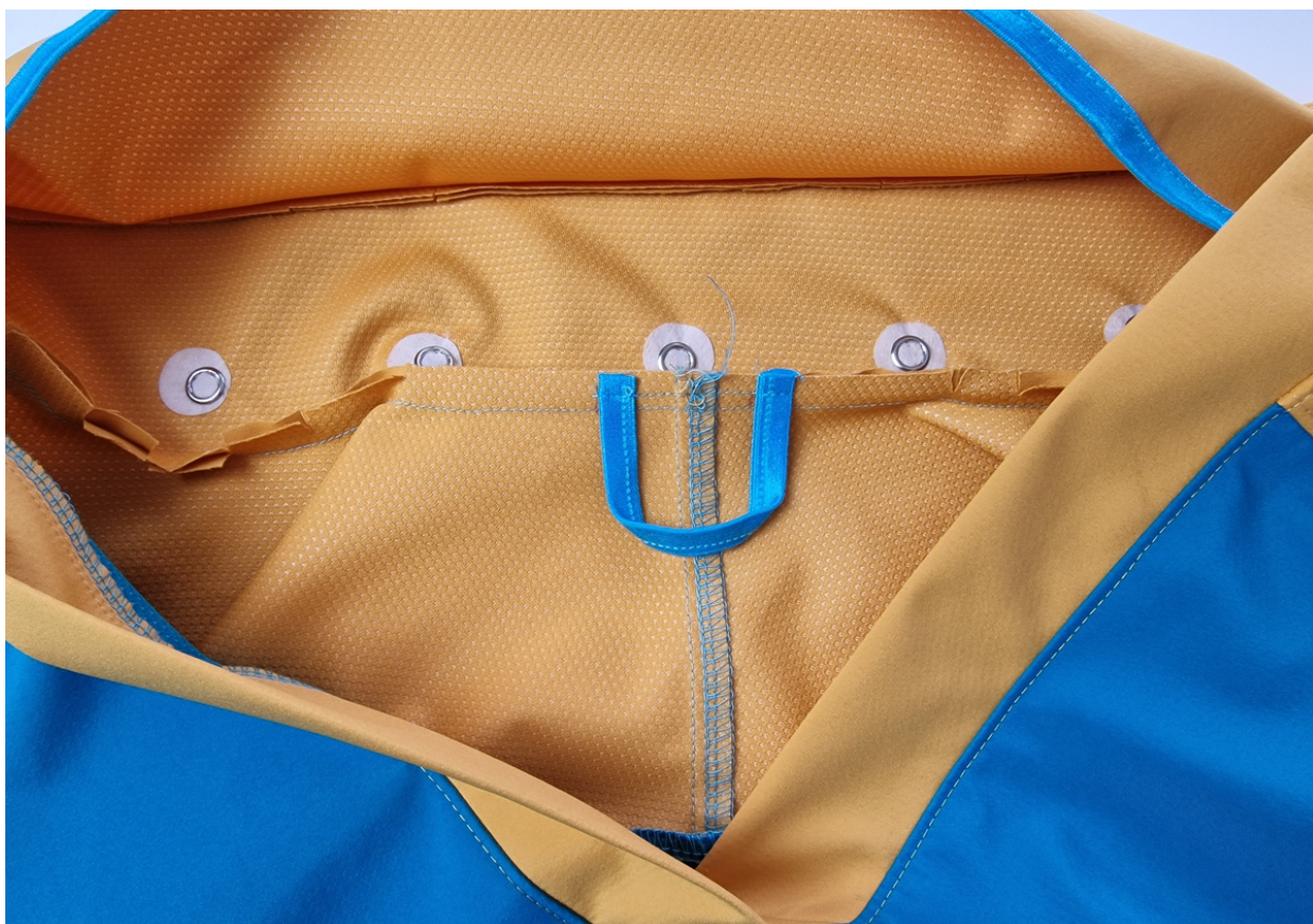
54. Z RS si na střed zadního průkrčníku přišijí poutko, které lze vytvořit z prošité lemovací pruženky (používejte trojrovňový pružný steh)
