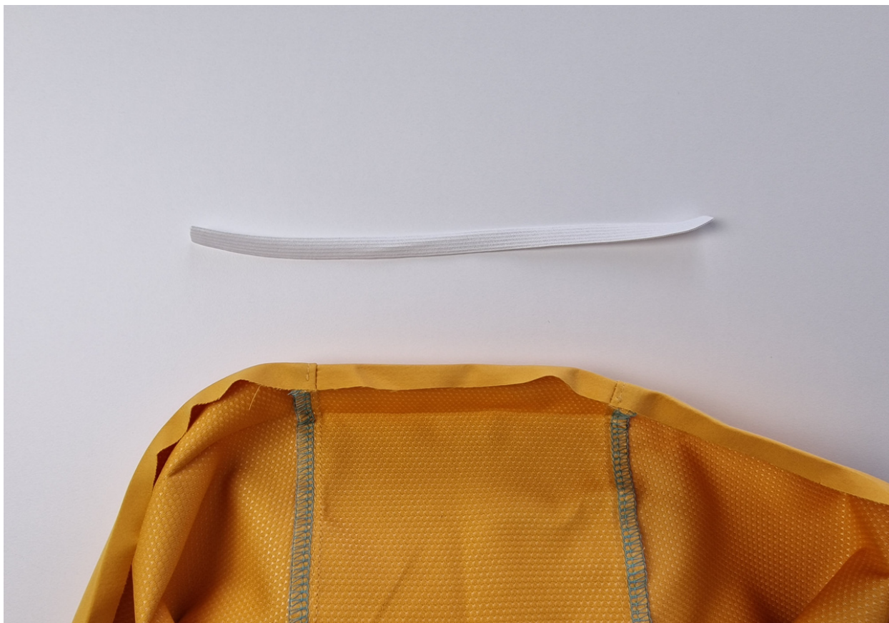
78. Připravíme si pruženku na zřasení horní části kapuce. Zřasená část bude od nástřihu k nástřihu, který je vyznačen na stříhu. Pruženka je dlouhá \frac{2}{3} délky změřené mezi nástřihy. Zažehlíme si 1cm kraje kapuce do RS a poté ještě 3cm.
